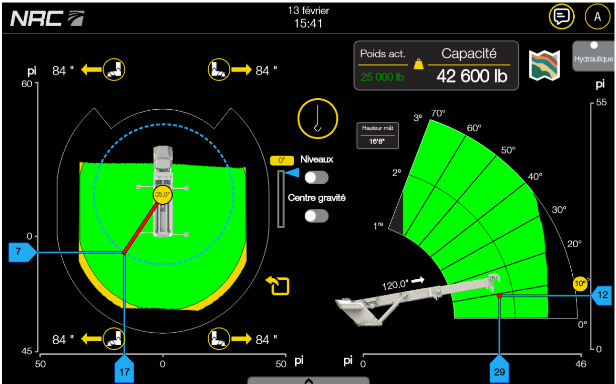
FIGURE 14 – ÉCRAN OPÉRATION – CAPACITÉ EN MODE LEVAGE
