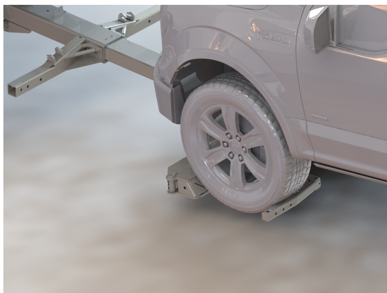
FIGURE 101 – SERRER LES BRAS EN L AUTOUR DES ROUES
