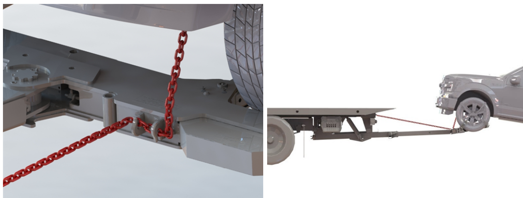
FIGURE 106 – FIXER LE VÉHICULE À LA PLATEFORME AVEC LES CHÂÎNES DE SÉCURITÉ
