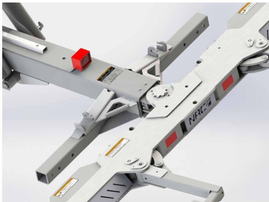
FIGURE 92 – EMBLACEMENT DE LA CAMÉRA DU LÈVE-ROUES À CHARGEMENT AUTOMATIQUE SUR LE LÈVE ROUES
