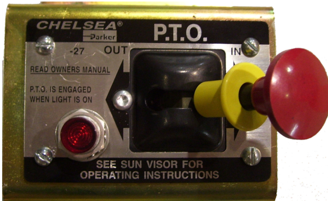
FIGURE 16 – COMMANDE D'UNE PRISE DE FORCE PNEUMATIQUE
