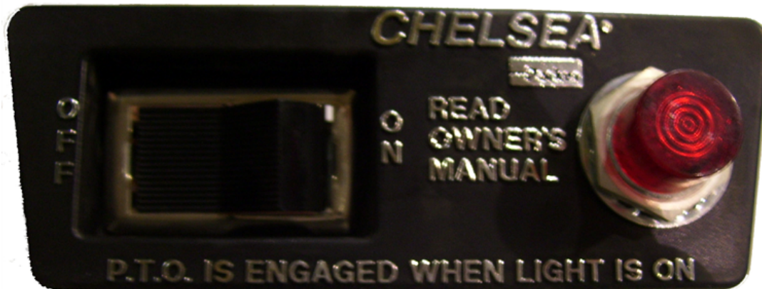
FIGURE 17 – COMMANDE D'UNE PRISE DE FORCE ÉLECTRIQUE
