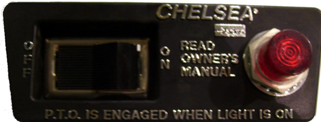
FIGURE 17 – COMMANDE D'UNE PRISE DE FORCE ÉLECTRIQUE
