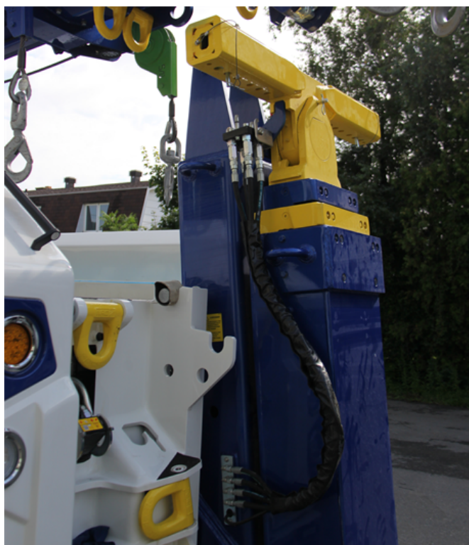
FIGURE 24 — PLACER LES CONDUITES HYDRAULIQUES DANS LE SUPPORT D'AMARRAGE (EXEMPLE)
