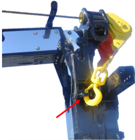
FIGURE 25 — FIXER LES CÂBLES AUX ŒILLETS (EXEMPLE)
