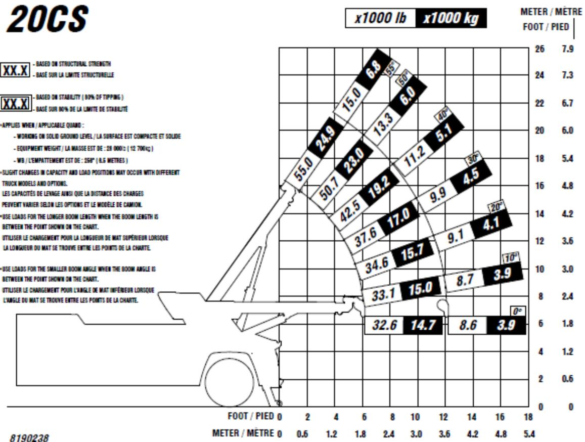
FIGURE 11 – CAPACITÉ DE LEVAGE DU MODÈLE 20CS
