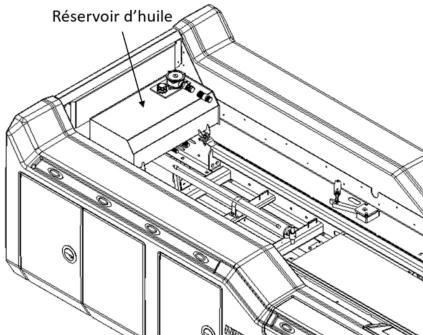
FIGURE 28 – RÉSERVOIR D'HUILE – 20CS ET 25CS
