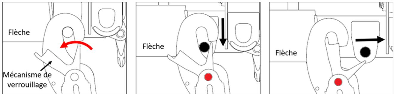
**FIGURE 18 – RELÂCHER LES MÉCANISMES DE VERROUILLAGE**
