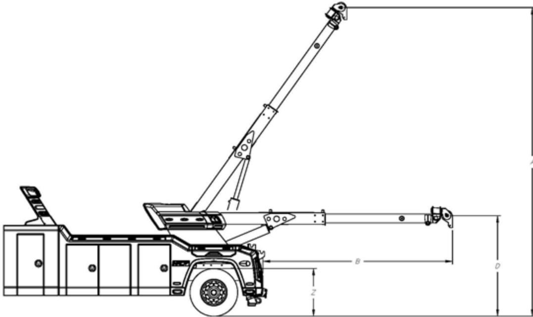
FIGURE 9 – DIMENSIONS DE LA FLÈCHE ET DES BÉQUILLES - VUE LATÉRALE (EXEMPLE)
