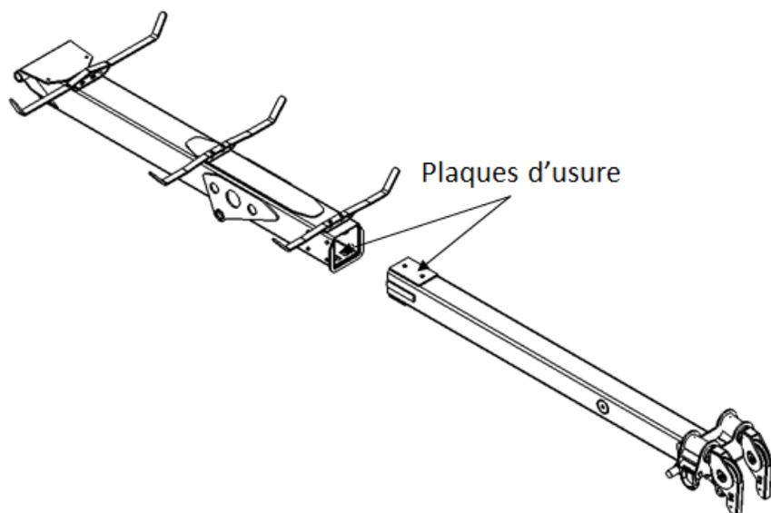
FIGURE 26 – PLAQUES D'USURE – FLÈCHE
