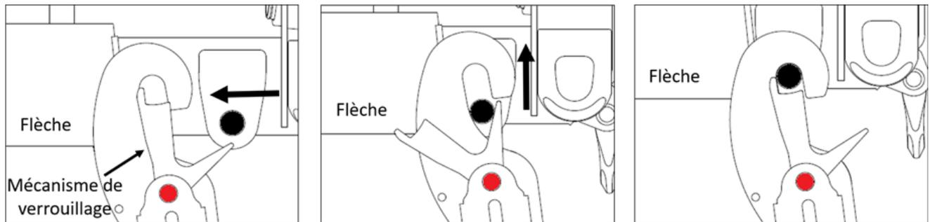
**FIGURE 19 – ACTIVER LES MÉCANISMES DE VERROUILLAGE**
