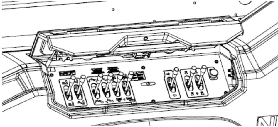
FIGURE 15 – PANNEAU DE COMMANDE DE LA DÉRIVATION HYDRAULIQUE D'URGENCE
