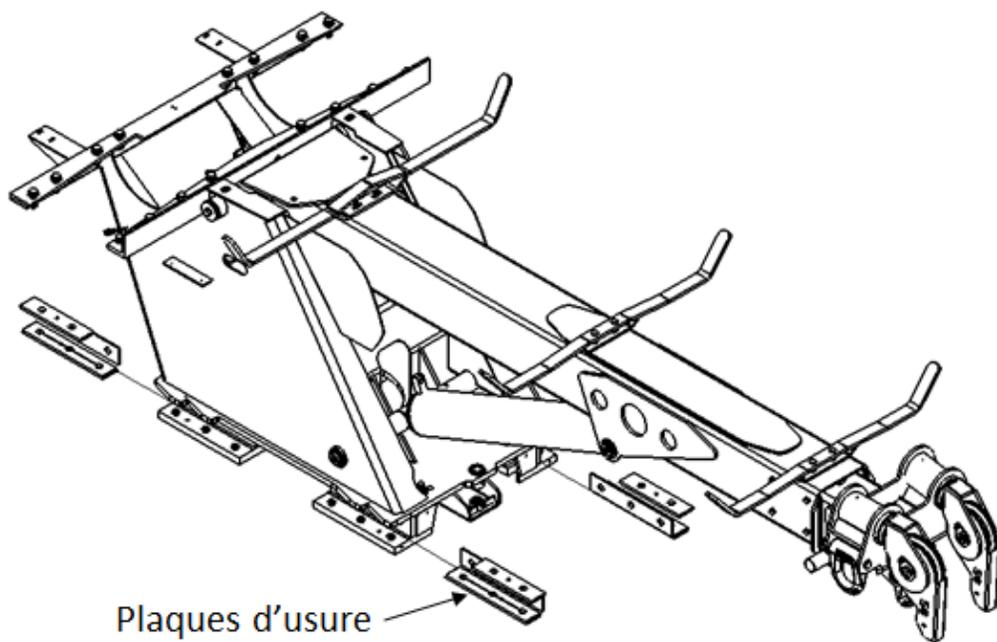
FIGURE 27 – PLAQUES D'USURE – SYSTÈME COULISSANT
