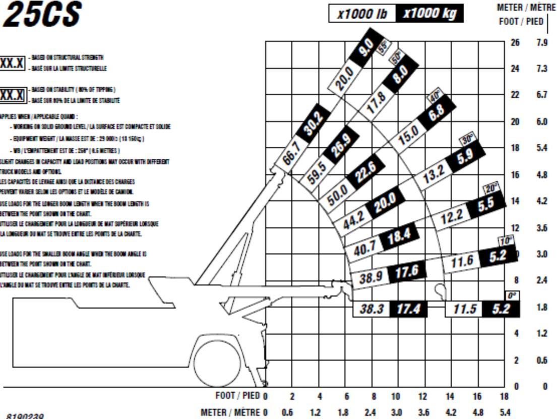
FIGURE 12 – CAPACITÉ DE LEVAGE DU MODÈLE 25CS
