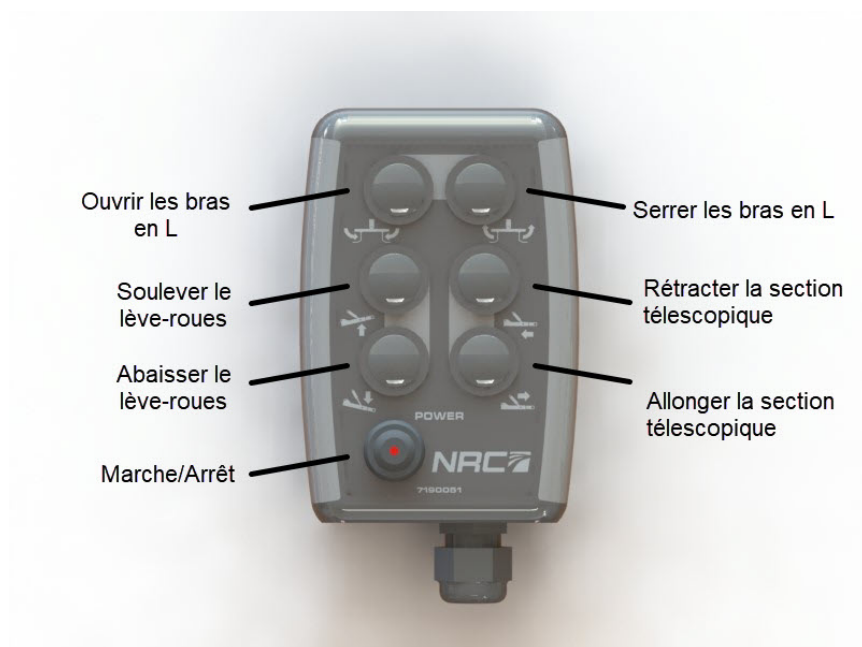
FIGURE 93 – TÉLÉCOMMANDE DU LÈVE-ROUES À CHARGEMENT AUTOMATIQUE
