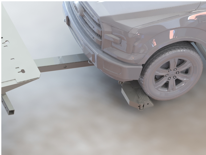
FIGURE 100 – TRAVERSE DE REMORQUAGE ENTRANT EN CONTACT AVEC LES ROUES AVANT (VUE RAPPROCHÉE)
