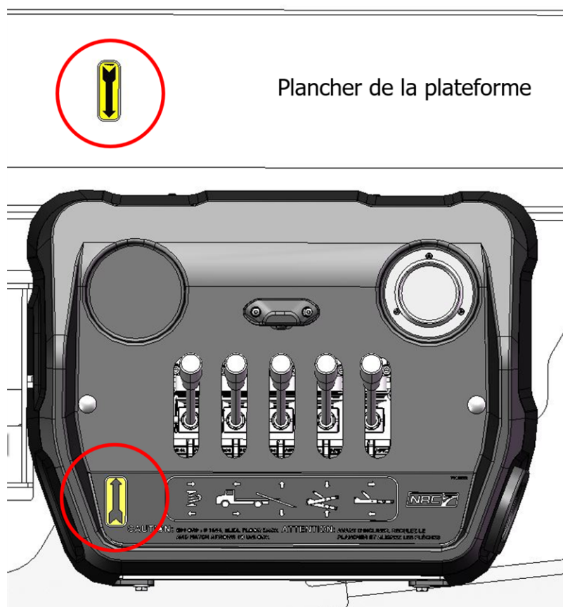
FIGURE 18 – GLISSER LE PLANCHER VERS L'ARRIÈRE
