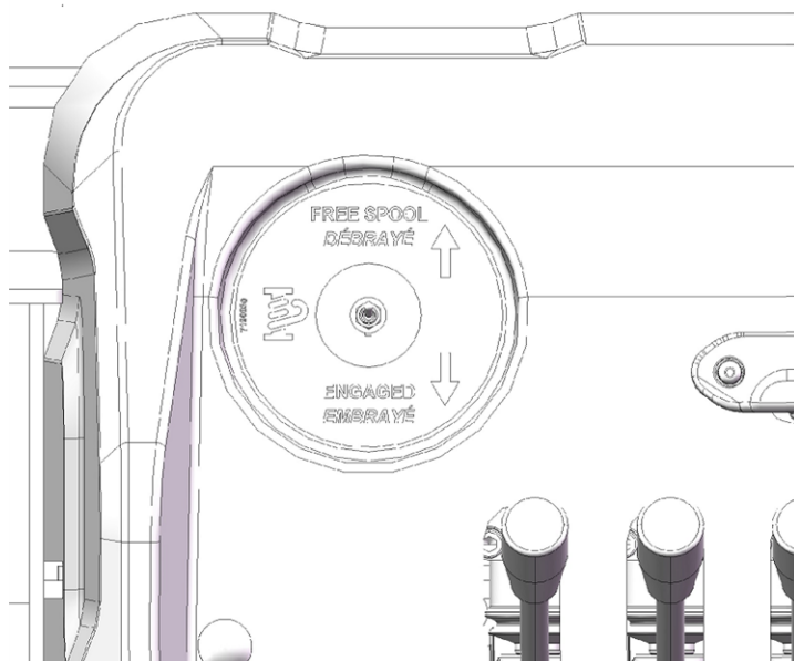
FIGURE 5 – COMMANDE DE DÉBRAYAGE DES TREUILS
