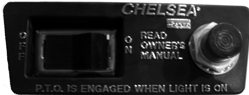
FIGURE 17 – COMMANDE D'UNE PRISE DE FORCE ÉLECTRIQUE
