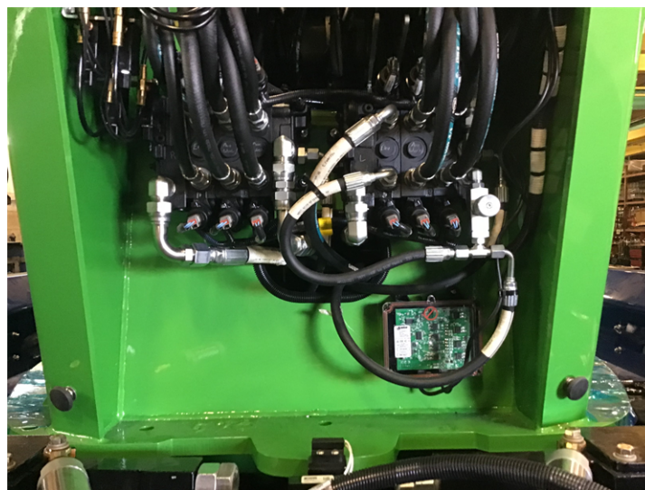
FIGURE 43 – EMPLACEMENT DES DISTRIBUTEURS DANS LA BASE DE LA FLÈCHE (CSR50 ET CSR65)
