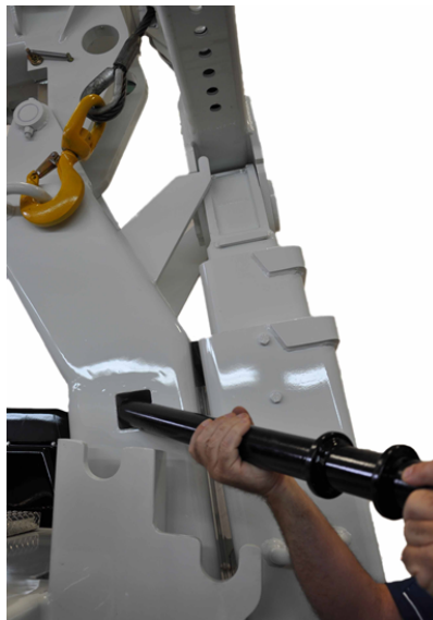
FIGURE 26 – INSÉRER L'AXE DE SUPPORT DU BRAS DE REMORQUAGE (EXEMPLE)
