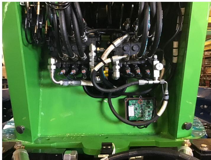
FIGURE 47 – EMBLACEMENT DES DISTRIBUTEURS DANS LA BASE DE LA FLÈCHE (CSR50 ET CSR65)
