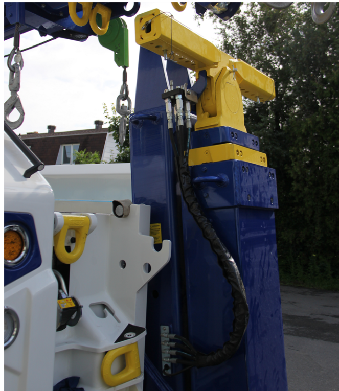
FIGURE 29 – PLACER LES CONDUITES HYDRAULIQUES DANS LE SUPPORT D'AMARRAGE (EXEMPLE)
