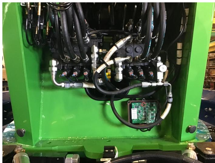
**FIGURE 46 – EMBLACEMENT DES DISTRIBUTEURS DANS LA BASE DE LA FLÈCHE (CSR50 ET CSR65)**
