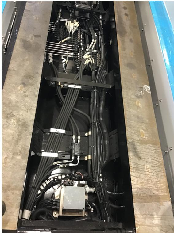
**FIGURE 51 – EMBLACEMENT DES DISTRIBUTEURS À L'INTÉRIEUR DE LA CARROSSERIE DE LA DÉPANNEUSE (CSR85)**
