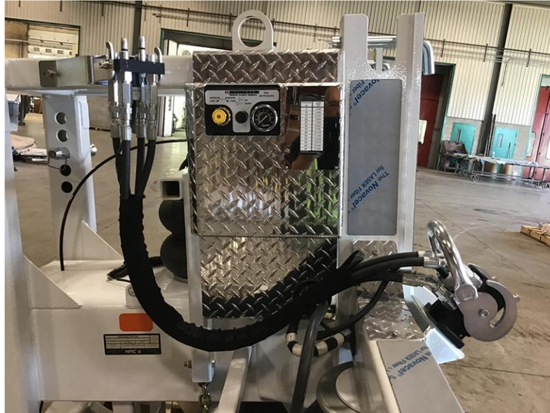
**FIGURE 34 – PLACER LES CÂBLES ET LES BOYAUX À AIR DANS LE SUPPORT D'AMARRAGE (EXEMPLE)**
