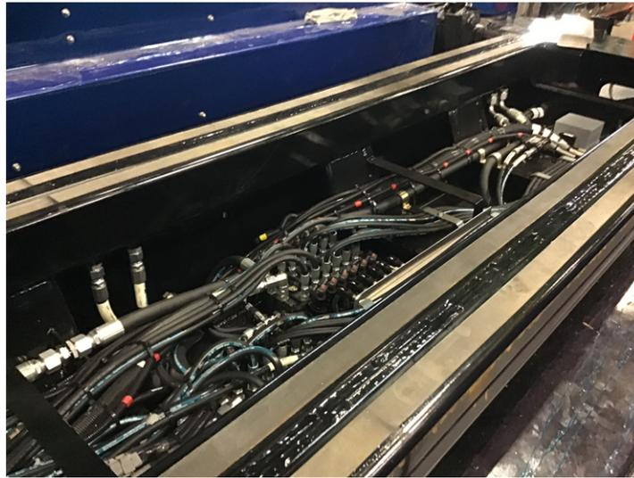
**FIGURE 47 – EMBLACEMENT DES DISTRIBUTEURS À L'INTÉRIEUR DE LA CARROSSERIE DE LA DÉPANNÉUSE (CSR50 ET CSR65)**
