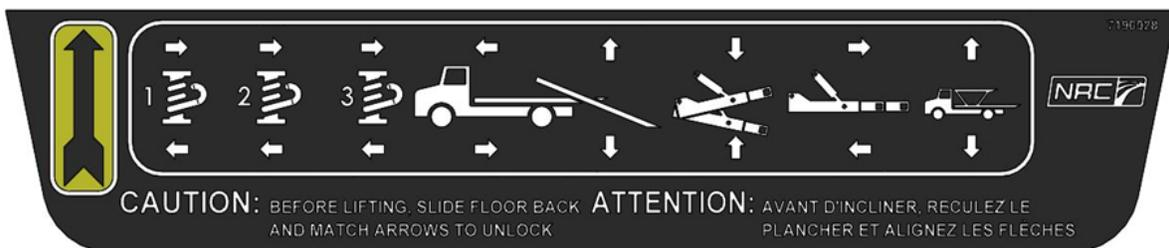
FIGURE 9 – ÉTIQUETTE DE LA BOÎTE DE COMMANDE PRINCIPALE (VERSION À 8 LEVIERS)
