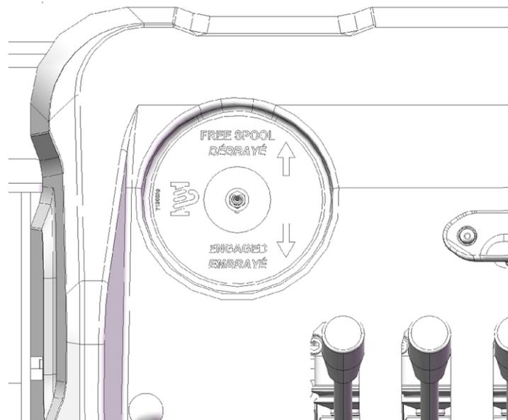
FIGURE 25 – INTERRUPTEUR DE DÉBRAYAGE ET D'EMBRAYAGE DU TREUIL
