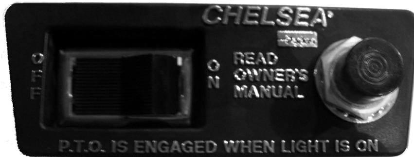
FIGURE 19 – COMMANDE D'UNE PRISE DE FORCE ÉLECTRIQUE
